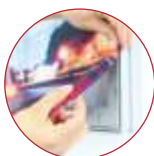
Grafika montowana za pomocą silikonowego obszycia
